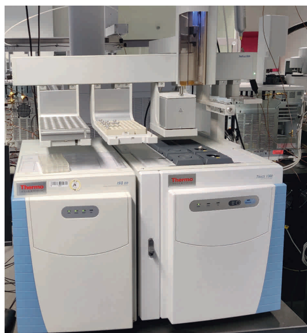
GC/MS für das Screening von flüchtigen Verbindungen
