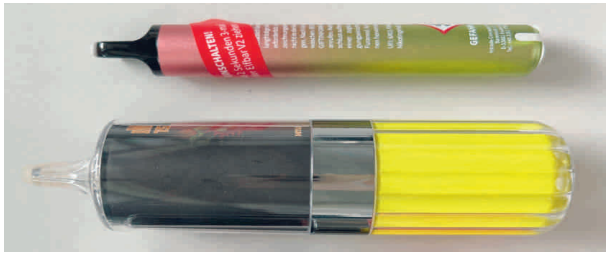
Vergleich: Oben: Eine Einweg-E-Zigarette mit 2 ml E-Liquid-Volumen Unten: Eine Verdachtsprobe mit deutlich über 2 ml
